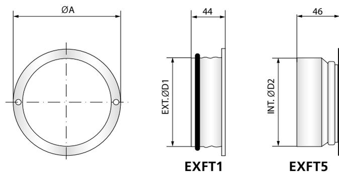
Abb. 5. Befestigungsrahmen EXFT1/EXFT5.
