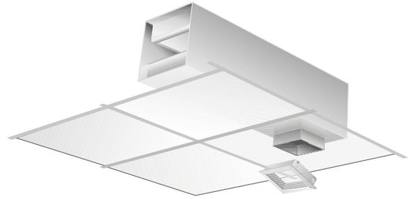
Montage von Befestigungsrahmen FHB und Gitter GRL an CTK
