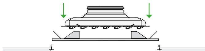
Figure 1. Ensemble ADAPTER et diffuseur 500.
