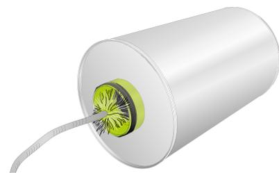
Abb. 2. Reinigung mit Kunststoffbürsten
