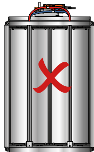
Abb. 6. Montage - Für rechteckige Kanäle wird die Klappe immer so montiert, dass der Regler/Stellantrieb parallel zum Kanal montiert wird.
