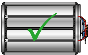
Abb. 6. Montage - Für rechteckige Kanäle wird die Klappe immer so montiert, dass der Regler/Stellantrieb parallel zum Kanal montiert wird.
