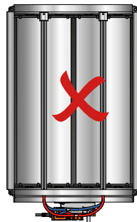
Abb. 6. Montage - Für rechteckige Kanäle wird die Klappe immer so montiert, dass der Regler/Stellantrieb parallel zum Kanal montiert wird.
