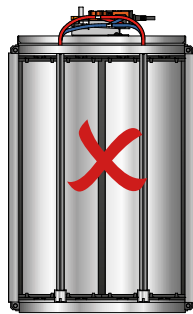
Abb. 6. Montage - Für rechteckige Kanäle wird die Klappe immer so montiert, dass der Regler/Stellantrieb parallel zum Kanal montiert wird.
