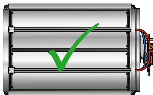
Abb. 8. Montage - Für rechteckige Kanäle wird die Klappe immer so montiert, dass der Regler/Stellantrieb parallel zum Kanal montiert wird.
