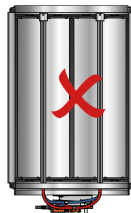
Abb. 8. Montage - Für rechteckige Kanäle wird die Klappe immer so montiert, dass der Regler/Stellantrieb parallel zum Kanal montiert wird.
