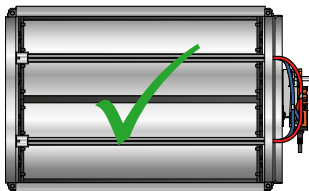
Abb. 8. Montage - Für rechteckige Kanäle wird die Klappe immer so montiert, dass der Regler/Stellantrieb parallel zum Kanal montiert wird.
