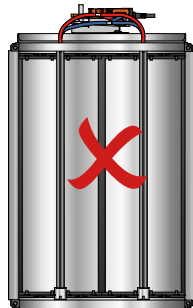
Abb. 8. Montage - Für rechteckige Kanäle wird die Klappe immer so montiert, dass der Regler/Stellantrieb parallel zum Kanal montiert wird.
