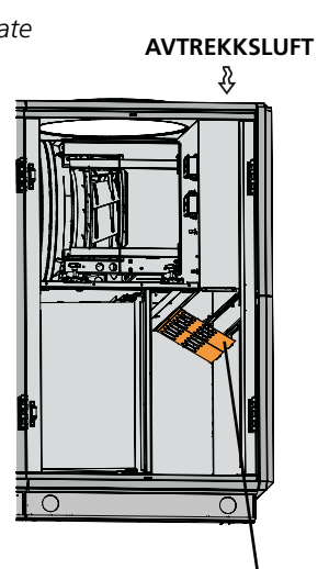
Justeringsplate Hekt fast justeringsplaten i sporet i siden mot filter. Vipp opp justeringsplaten mot aggregatkabinettet og hekt fast i sporet.
