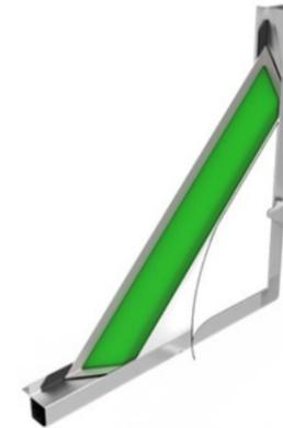
Section de la boîte GLOBAL SD (isolant en laine rocheuse)
