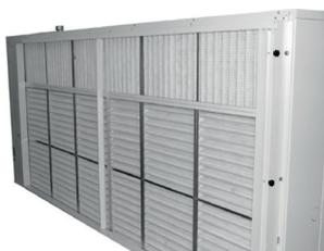
Der Filterrahmen für den Anschluss an ein Lüftungskanalnetz wird als Zubehör geliefert. Der Filter kann durch Öffnen der Knöpfe an der Verschlussblende entnommen werden.
