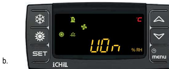
Halten sie die Taste 5 Sekunden gedrückt, um das Gerät auszuschalten. Das Gerät geht in Standby.
