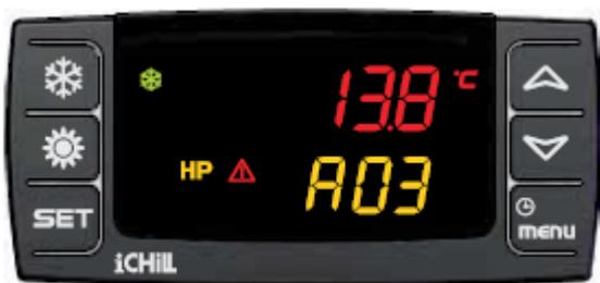
Eine Störung wird im unteren rechten Teil des Displays durch
