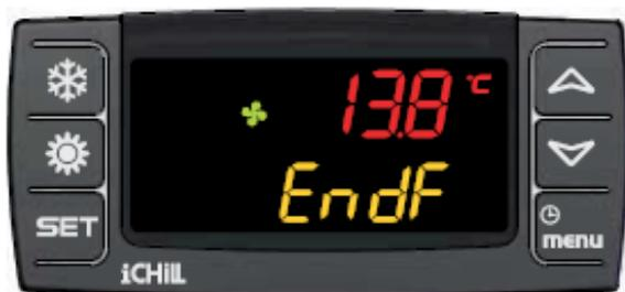
Anzeige der Abtropfzeit nach Abtauung bei Geräten mit integriertem Feuchte- /Temperaturfühler (Standard).
