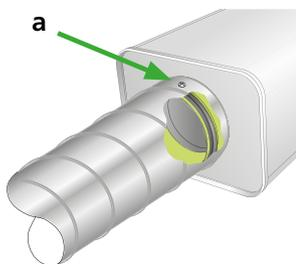
Abb 1. Befestigen Sie den Anschlusskanal mit einer Schraube oder Blindniete (a) an der erhöhten Blechkante, die in die Anschlussbuchse eingegossen ist.
