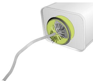
Abb. 2. Reinigung mit Kunststoffbürsten
