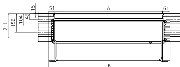
Figur 11. Vy: front. A = Utloppsstos, B = Längd
