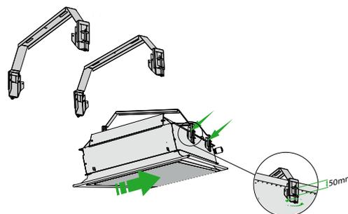
Figure 20. Fixation au moyen du KIT DE SUSPENSION RAPIDE PARASOL Z
