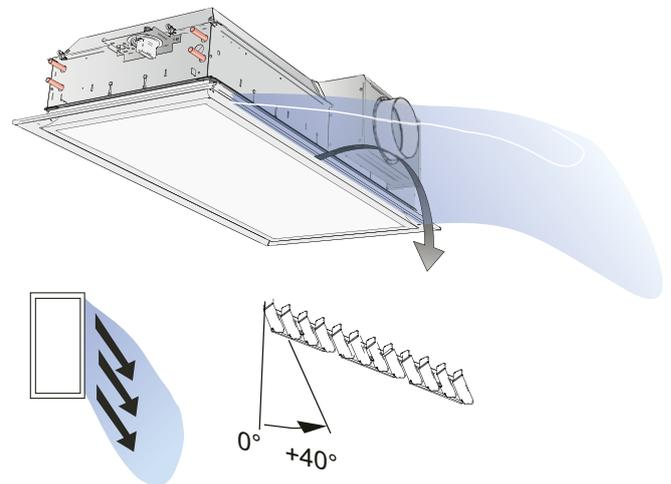
Figure 9. Options de réglage de l'ADC, en X
