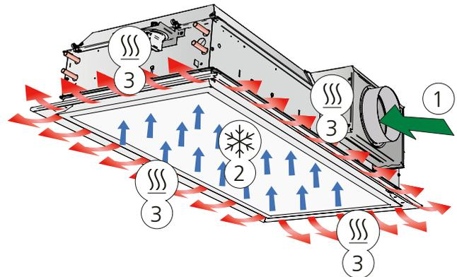
Figure 3. Version B : Chauffage et ventilation
