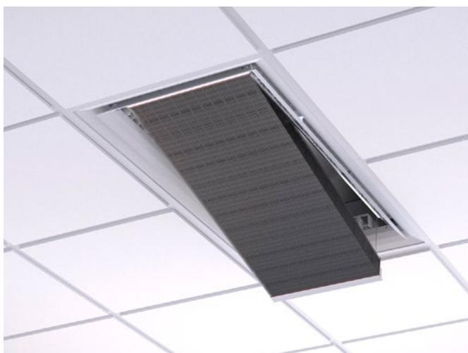
Figure 13. Dépose de la sous-face et sortie de la batterie pour un nettoyage poussé en cas d'exigences strictes en matière d'hygiène. Attention: le produit doit être commandé avec la batterie escamotable (option) et l'alimentation en eau doit se faire par le biais de flexibles de raccordement.
