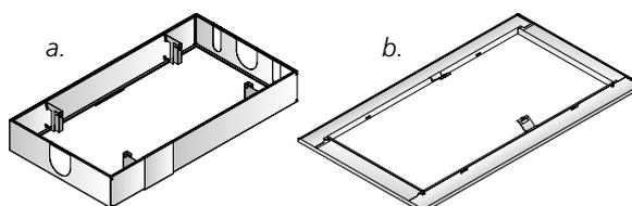
Figure 22. Accessoires pour montage suspendu
