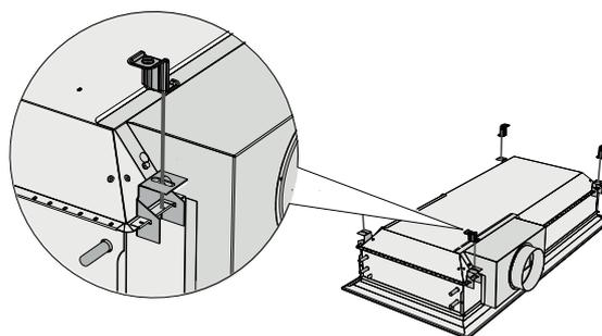
Figure 19. Suspension par quatre consoles avec SYST MS M8
