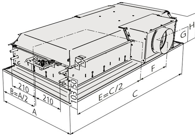
Figure 27. Schéma de dimensionnement - raccordement aéraulique côté longueur (la longueur 1200 avec raccordement hydraulique sur le côté 2 est montrée dans l'exemple).
