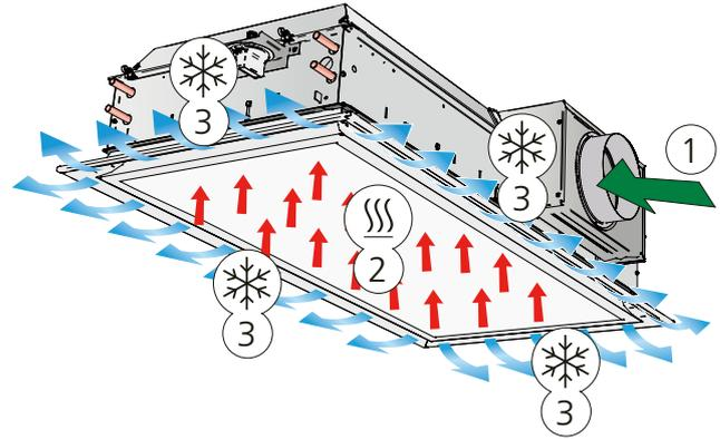
Figure 2. Version A : Refroidissement et ventilation
