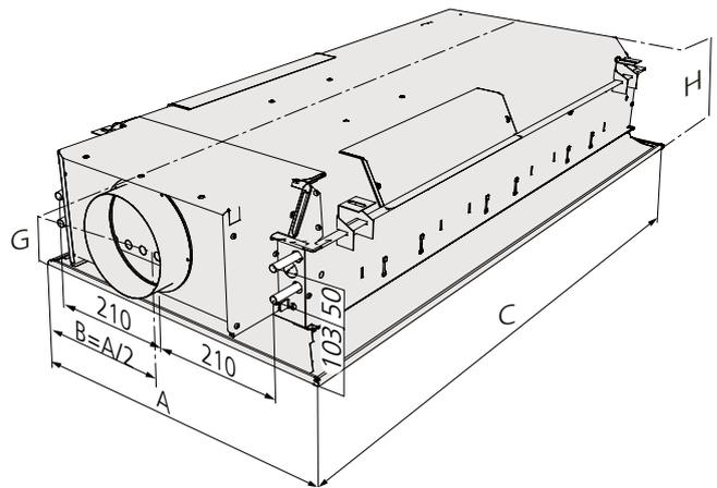
Figure 28. Schéma de dimensionnement - raccordement aéraulique côté largeur (la longueur 1200 avec raccordement hydraulique sur le côté 1 est montrée dans l'exemple).
