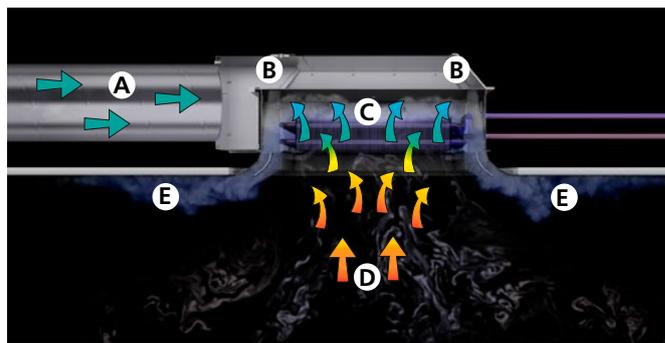
Figure 4. Parasol Zenith – principe d'induction
