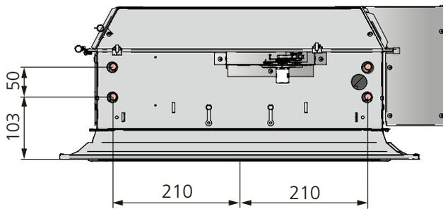
Figure 23. Dimensions, longueur raccord eau 600, 1200, 1800
