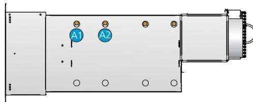
Abb. 22. Wasseranschluss auf der linken Seite (L).
