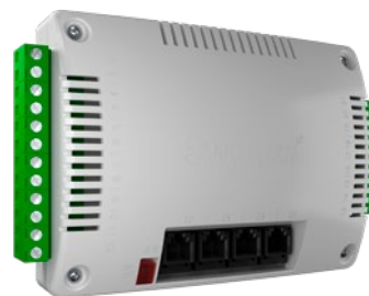
Figure 11. Régulateur VAV pour ventilation à la demande
