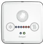
Erhöhen Sie die Temperatur durch Drücken der rechten Taste.
