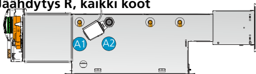
Kuva 22. Vesiliitântä oikealla puolella (R).
