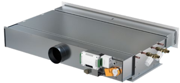
Abb. 11. PARAGON AWC, komplett mit werkseitig montiertem Regler, Stellantrieb, Drucksensor sowie Ventilen und Stellantrieben für Kühl- und Heizwasser.
