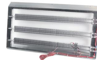
La batterie de chauffage électrique est utilisée pour réchauffer l'air soufflé. La batterie de chauffage se trouve entre l'échangeur de chaleur rotatif et le ventilateur d'air soufflé. La batterie de chauffage est équipée de deux dispositifs de protection contre la surchauffe, l'un avec réinitialisation manuelle (110 °C) et l'autre avec réinitialisation automatique (75 °C). Toutes les connexions électriques sont protégées afin d'empêcher les personnes de les toucher.
