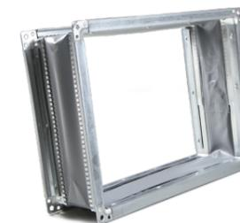
Les raccords flexibles de type MS30 empêchent les vibrations de se propager dans le circuit de gaines. Les raccords sont en plastique armé de fibre de verre ; ils ont une résistance au feu de classe M0 et une étanchéité à l'air de classe B (selon EN 15727 et EN 1751).
