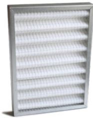
Le pré-filtre est installé dans la section air extérieur, en amont du filtre fin. Un pré-filtre est utilisé lorsque l'air extérieur est très pollué afin d'éviter que le filtre fin se colmate à une vitesse déraisonnable. Le pré-filtre relève de la classe de filtration G4 selon EN-779.
