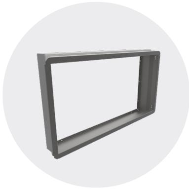
Die extern isolierten Gehäuse werden aus verzinktem Stahlblech gefertigt. Das Außenblech ist in RAL 7016 lackiert. Die doppelwandige Verkleidung enthält 50 mm Mineralwolle. Die Gehäuse sind für die Aufnahme externer Kühlung, Heizung oder direkter Ausdehnungsregister (EBA) ausgelegt. Der standardmäßige Anschlussrahmen ist 15 mm stark. Andere Anschlussrahmentypen sind optional erhältlich: 20-mm-Gleitklemmen, 30-mm-„METU“-Rahmen.
