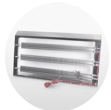
Das elektrische Register wird zur Nachheizung der Zuluft verwendet. Das Register befindet sich zwischen rotierendem Wärmetauscher und Ventilator. Es sind zwei Überhitzungsschutzeinrichtungen vorhanden, eine mit manueller und eine mit automatischer Rückstellung. Alle elektrische Anschlüsse sind vor Stromschlag geschützt.
