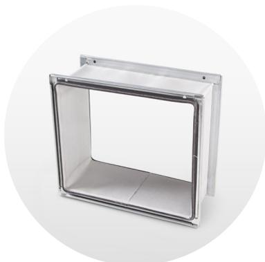
Die flexiblen Hüllen vom Typ MS20 verhindern die Übertragung von Vibrationen und Geräuschen an den Lüftungskanälen. Die Hülse besteht aus Glasfaser und ist gemäß „M0“ für eine Feuerbeständigkeit sowie gemäß „Klasse B“ für Luftdichtheit klassifiziert (EN 15727 und EN 1751). Der Betriebsbereich reicht von -30 bis +110°C und ist für Drücke bis 2000 Pa ausgelegt. Der 20-mm-Anschlussrahmen besteht aus verzinktem Stahl mit einer Stärke von 1 mm.
