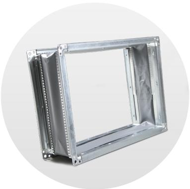
Die flexiblen Hülse vom Typ MS30 verhindern die Übertragung von Vibrationen und Geräuschen an den Lüftungskanälen. Die Hülse besteht aus Glasfaser und ist gemäß „M0“ für eine Feuerbeständigkeit sowie gemäß „Klasse B“ für Luftdichtheit klassifiziert (EN 15727 und EN 1751). Der Betriebsbereich reicht von -30 bis +110°C und ist für Drücke bis 2000 Pa ausgelegt. Der 30-mm-„METU“-Anschlussrahmen besteht aus verzinktem Stahl mit einer Stärke von 1 mm.
