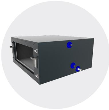
Die extern isolierten Gehäuse werden aus verzinktem Stahlblech gefertigt. Das Außenblech ist in RAL 7016 lackiert. Die doppelwandige Verkleidung enthält 30 mm Mineralwolle. Die Gehäuse sind für die Aufnahme externer Kühlung, Heizung oder direkter Ausdehnungsregister (EBA) ausgelegt. Der standardmäßige Anschlussrahmen ist 15 mm stark. Andere Anschlussrahmentypen sind optional erhältlich: 20-mm-Gleitklemmen, 30-mm-„METU“-Rahmen.
