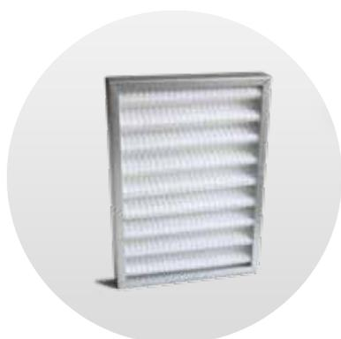
Der Vorfilter ist im Außenluftbereich installiert und befindet sich vor dem Feinfilter. Der Vorfilter wird verwendet, wenn die Außenluft stark verschmutzt ist. Die Standzeit der Feinfilter wird somit erhöht. Gemäß ISO 16890 entspricht der Vorfilter Klasse coarse 65%.
