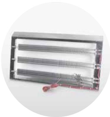
Das elektrische Register wird zur Nachheizung der Zuluft verwendet. Es sind zwei Überhitzungsschutzeinrichtungen vorhanden, eine mit manueller (110°C) und eine mit automatischer (75°C) Rückstellung.
