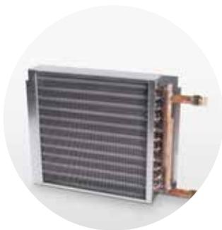
Das EBA-Register verwendet Warmwasser zur Nachheizung von Zuluft. Das Register wird in ein isoliertes ECA-Gehäuse integriert. Die Rippenrohr-Wärmetauscher bestehen aus Kupferrohren und Aluminiumlamellen mit einem Abstand von 2,5 mm. Das Außengewinderohr ist aus Messing gefertigt. Die Register sind mit einem Stecker zum Entlüften ausgerüstet. Die Register sind gemäß PN16 klassifiziert.
