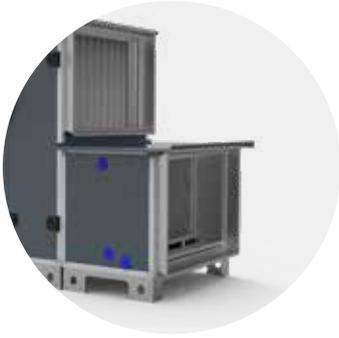
Die extern isolierten Gehäuse werden aus verzinktem Stahlblech gefertigt. Das Außenblech ist in RAL 7016 lackiert. Die doppelwandige Verkleidung enthält 30 mm Mineralwolle. Die Gehäuse sind für die Aufnahme externer Kühl- oder Heizregister (EBA) ausgelegt.
