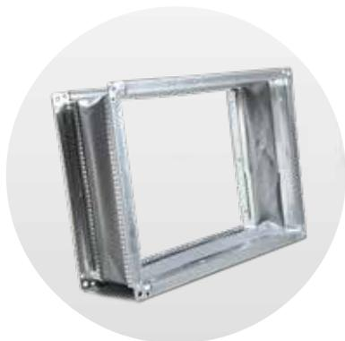
Die flexiblen Verbindung vom Typ MS30 verhindern die Übertragung von Vibrationen und Geräuschen an den Lüftungskanälen. Die flexible Verbindung besteht aus Glasfaser und ist gemäß „M0“ für eine Feuerbeständigkeit sowie gemäß „Klasse B“ für Luftdichtheit klassifiziert (EN 15727 und EN 1751). Der Betriebsbereich reicht von -30°C bis +110°C und ist für Drücke bis 2000 Pa ausgelegt. Der 30-mm-„METU“-Anschlussrahmen besteht aus verzinktem Stahl mit einer Stärke von 1 mm.
