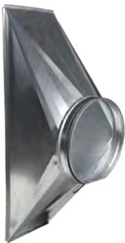
Für Geräte (AHUs, externe Register usw.) mit rechteckigen Anschlüssen sind nicht-isolierte rechteckige/runde Adapter erhältlich. Der Adapter wird aus verzinktem Metallblech gefertigt. Die runden Kanalanschlüsse sind mit einer doppelten Gummidichtung versehen.
