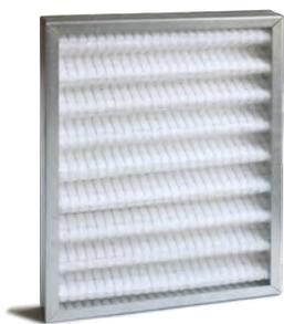
Der Vorfilter ist im Außenluftteil installiert und befindet sich vor dem Feinfilter. Der Vorfilter wird verwendet, wenn die Außenluft stark verschmutzt ist und verhindert werden soll, dass der Feinfilter bereits nach kurzer Betriebszeit verschmutzt ist. Gemäß DIN ISO 16890 entspricht der Vorfilter der Klasse Coarse.
