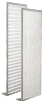
Mithilfe des Filters sollen die Luft und der Wärmetauscher sauber gehalten werden. Filterklasse des Zuluftfilters: ePM1  $\geq$  60 %. Filterklasse des Abluftfilters: ePM10  $\geq$  50 %. Alle Filter sind sowohl nach ISO EN 779 als auch nach ISO EN 16890 klassifiziert. Um den Wärmetauscher sauber zu halten, genügt Filterklasse ePM10  $\geq$  50 %. Ein Filter vom Typ ePM1  $\geq$  50 % auf der Abluftseite ist nicht verfügbar, da er sich negativ auf den Energieverbrauch auswirken würde.
