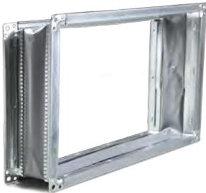
Die flexiblen Stutzen vom Typ MS30 verhindern die Übertragung von Vibrationen und Geräuschen über die Lüftungskanäle. Der flexible Stutzen besteht aus Glasfaser und ist als „M0“ für die Feuerbeständigkeit sowie „Klasse B“ für Luftdichtheit klassifiziert (EN 15727 und EN 1751). Der Betriebsbereich reicht von -30 bis +110 °C und ist für Drücke bis 2000 Pa ausgelegt. Der 30-mm-„METU“-Anschlussrahmen besteht aus verzinktem Stahl mit einer Stärke von 1 mm.
