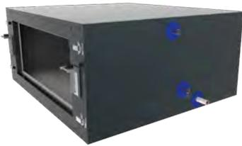
Die extern isolierten Gehäuse werden aus verzinktem Stahlblech gefertigt. Das Außenblech ist in RAL 7016 lackiert. Die doppelwandige Verkleidung enthält 30 mm dicke Mineralwolle. Die Gehäuse sind für die Aufnahme externer Kühl- oder Heizregister (EBA) ausgelegt. Der standardmäßige Anschlussrahmen ist 15 mm stark. Andere Anschlussrahmentypen sind optional erhältlich: 30-mm-„METU“-Rahmen.
