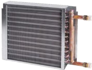
Das EBA-Register verwendet Warmwasser zur Nachheizung von Zuluft. Das Register wird in ein isoliertes ECA-Gehäuse integriert. Die Rippenrohr-Wärmetauscher bestehen aus Kupferrohren und Aluminiumlamellen. Das Außengewinderohr ist aus Messing gefertigt. Die Register verfügen über einen Stöpsel zum Entlüften. Die Register sind gemäß PN16 klassifiziert.
