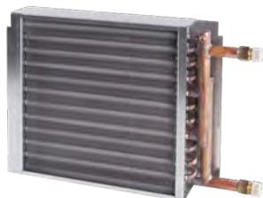
Das IBA-Register verwendet Warmwasser zur Nachheizung von Zuluft. Das Register ist in das Gerät integriert und befindet sich zwischen dem Wärmetauscher und dem Luftauslass. Die Rippenrohr-Wärmetauscher bestehen aus Kupferrohren und Aluminiumlamellen mit einem Abstand von 2,5 mm. Das Außengewinderohr ist aus Messing gefertigt. Die Register sind mit einem Entlüftungstopfen ausgestattet.. Die Register sind gemäß PN16 klassifiziert.
