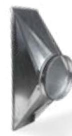
Des adaptateurs non isolés permettant la transition entre des raccords circulaires et rectangulaires, sont disponibles pour les unités et sections de post-traitement à raccords rectangulaires. Les adaptateurs sont en tôle d'acier galvanisé. Le raccord circulaire est doté d'un joint caoutchouc.
