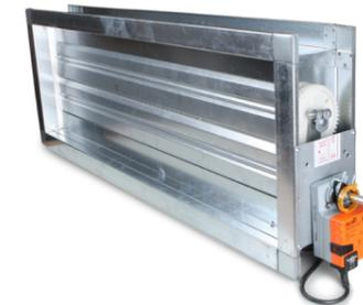
Les unités GLOBAL LP FW peuvent être équipées de clapets de fermeture motorisés livrés pré-câblés permettant de couper les courants d'air lors de l'arrêt de l'appareil. Ils sont livrés avec un servomoteur pré-câblé et sont entièrement contrôlés par la régulation. Une temporisation du démarrage des ventilateurs est prévue afin de permettre l'ouverture préalable des clapets.
