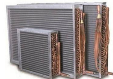
Ce module externe, prévu spécialement pour les GLOBAL LP<sup>FW</sup>, peut être monté sur la gaine de pulsion ou directement sur l'unité. Il comprend une batterie à eau (chaude/froide) ou à condensation/évaporation à 4 rangs qui sert de pré- et/ou postchauffe pour l'air neuf. Si le module inclus une batterie à eau, il est livré prêt à connecter sur le circuit hydraulique (chaud/froid) avec régulation et vanne 3 voies motorisée. Il suffit ensuite
