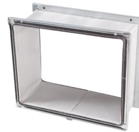
I collegamenti canali flessibili di tipo MS20 impediscono la propagazione delle vibrazioni nel sistema di canali. I collegamenti sono realizzati in plastica rinforzata con fibra di vetro e hanno una classe di resistenza al fuoco M0 e una classe di tenuta all'aria B (secondo EN 15727 ed EN 1751). Possono sopportare temperature operative da -30 a +110 °C e pressioni fino a 2000 Pa. Il collegamento a manica di larghezza 20 mm è realizzato in lamiera di acciaio galvanizzato da 1 mm di spessore.
