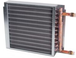
Nel recuperatore di calore EBA, si usa acqua o refrigerante per il post-trattamento dell'aria di mandata. Il recuperatore di calore è progettato per l'integrazione in alloggiamenti ECA isolati. Il recuperatore di calore è uno scambiatore di calore a tubo, realizzato con tubi in rame dotati di pinne in alluminio distanziate di 2,5 mm. I tubi hanno raccordi con filettatura esterna e sono in ottone. Il recuperatore di calore è dotato di tappo di sfiato (non per DX). La classe di pressione è PN16.
