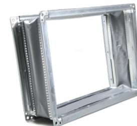
I collegamenti flessibili di tipo MS30 impediscono la propagazione delle vibrazioni nel sistema di canali. I collegamenti sono realizzati in plastica rinforzata con fibra di vetro e hanno una classe di resistenza al fuoco M0 e una classe di tenuta all'aria B (secondo EN 15727 ed EN 1751). Possono sopportare temperature operative da -30 a +110 °C e pressioni fino a 2000 Pa. Il collegamento a manica "METU" di larghezza 30 mm è realizzato in lamiera di acciaio galvanizzato da 1 mm di spessore.
