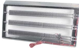
Il riscaldatore elettrico viene usato per scaldare nuovamente l'aria di mandata, mentre il preriscaldatore viene usato per evitare che l'acqua geli nel recuperatore di calore con scambio controcorrente. Questi sono equipaggiati con due unità di protezione dal surriscaldamento, una con reset manuale (110°C) e una con reset automatico (75°C). Tutti i collegamenti elettrici sono protetti, per evitare che il personale li tocchi accidentalmente.
