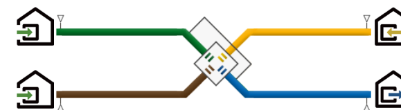
Échangeur de chaleur à plaques
