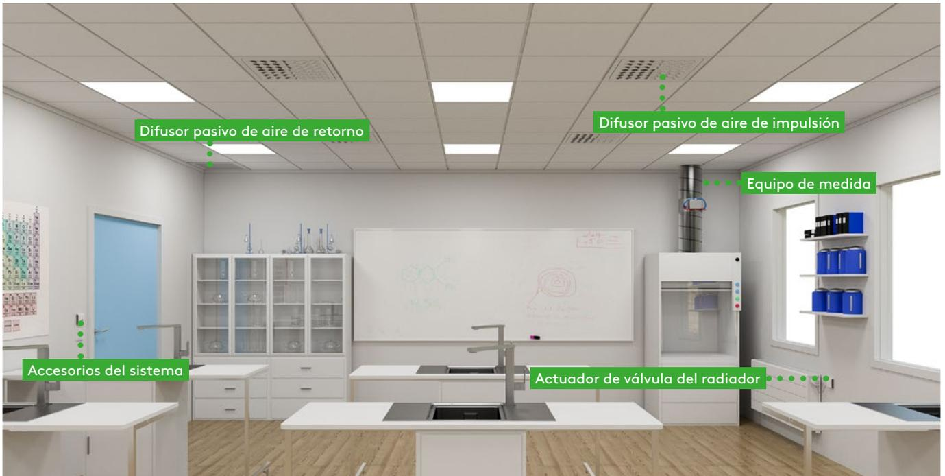
La medición de temperatura del aire interior se realiza en la compuerta de aire de retorno y el sistema regula la cantidad de impulsión y de retorno en el aula para alcanzar la climatización interior correcta.
