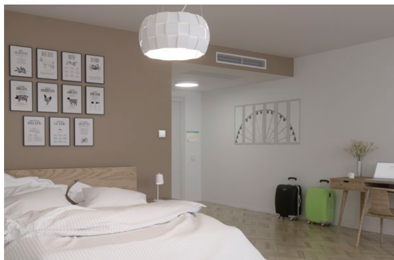
Pokój hotelowy z przetłaczniakiem wyboru wartości zadanej, chłodzeniem i ogrzewaniem na bazie wody oraz sterowaną zapotrzebowaniem regulacją powietrza. Gniazdo na kartę wykrywające obecność w pokoju.
