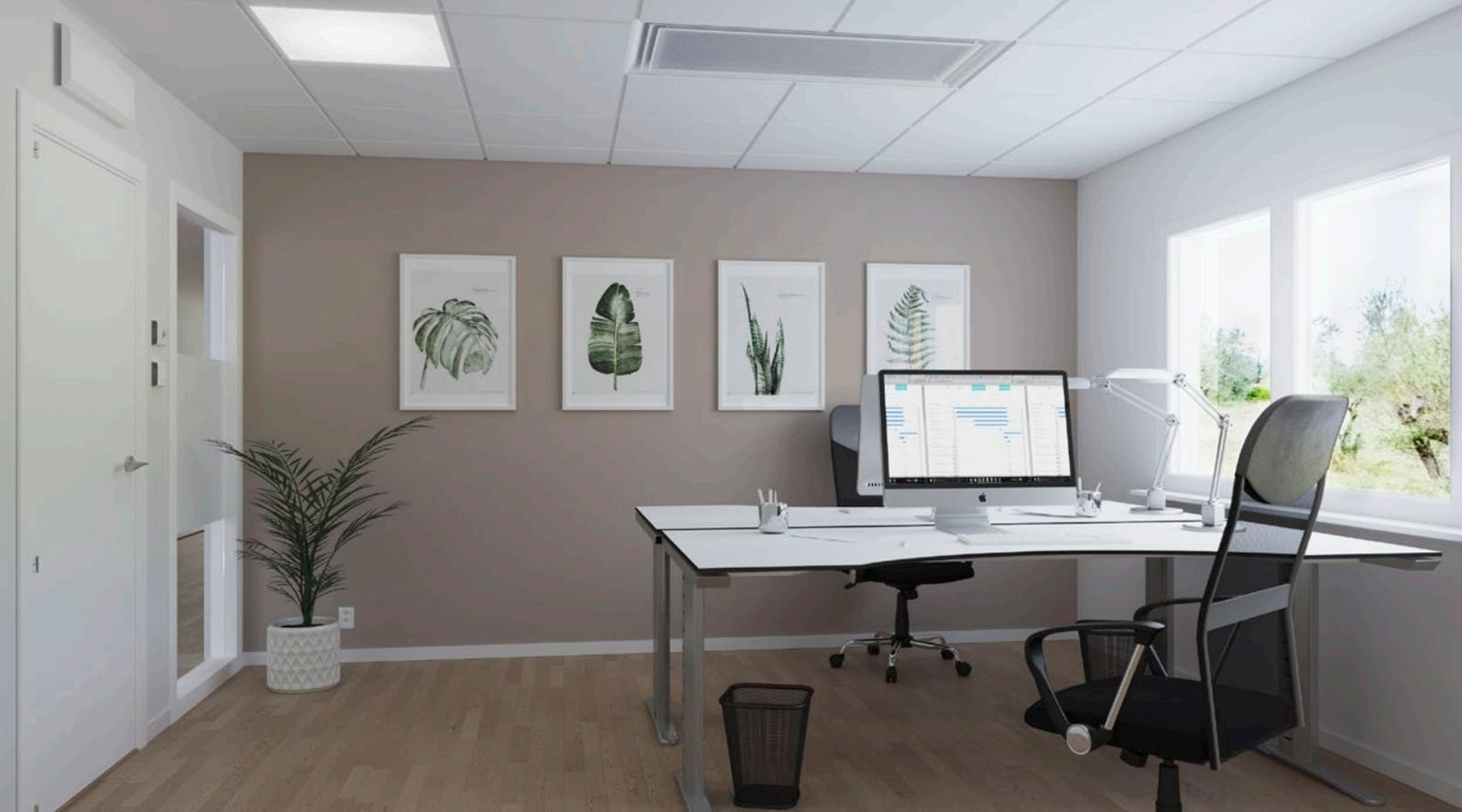
Bureau à climatisation à induction par eau avec sélecteur de point de consigne et détecteurs de présence pour ventilation, refroidissement et chauffage à la demande.
