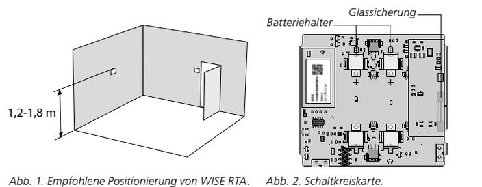
Abb. 1. Empfohlene Positionierung von WISE RTA.
