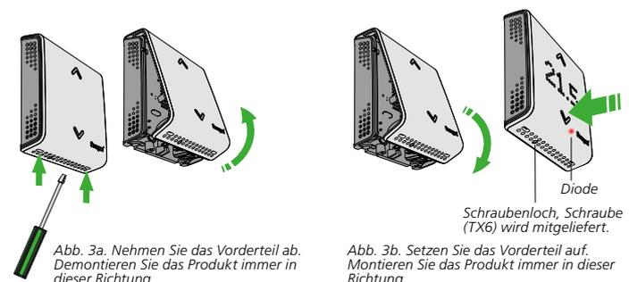
Abb. 3a. Nehmen Sie das Vorderteil ab. Demontieren Sie das Produkt immer in dieser Richtung.
