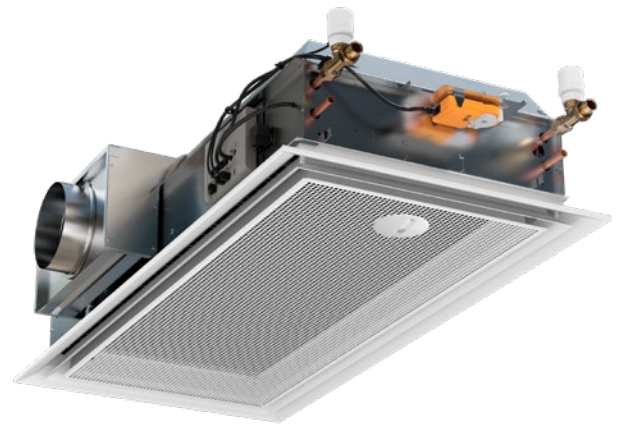
Kuva 3. WISE Parasol Zenith toimitetaan ilmaliitäntä sivulla 4 ja ohjauslaitteisto asennettuna.
