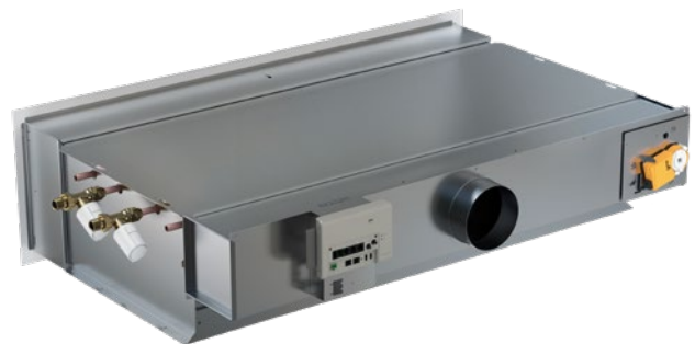
Figura 12. WISE Paragon Wall con raccordo per l'acqua sul lato sinistro. Prodotto completo con centralina WISE CU installata di fabbrica, attuatori, valvole e attuatori valvole per l'acqua di raffreddamento e di riscaldamento.
