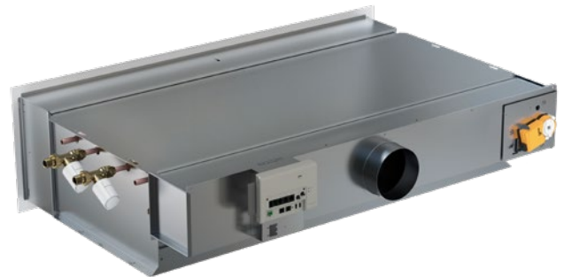
Figur 11. WISE Paragon Wall, komplett med fabriksmonterad styrenhet WISE CU, ställdon, samt ventiler och ventilställdon för kyl och värmevatten.
