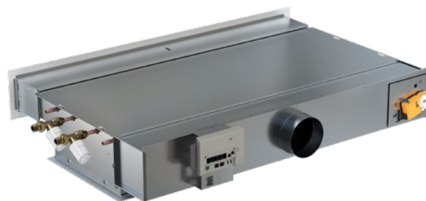
Figur 12. WISE Paragon med vattenanslutning på vänster sida. Komplet produkt med fabriksmonterad styrenhet WISE CU, ställdon, samt ventiler och ventilställdon för kyl- och värmevatten.
