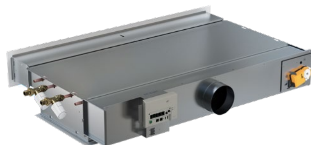
Figura 12. WISE Paragon con raccordo per l'acqua sul lato sinistro. Prodotto completo con centralina WISE CU installata di fabbrica, attuatori e valvole e attuatori valvole per l'acqua di raffreddamento e di riscaldamento.
