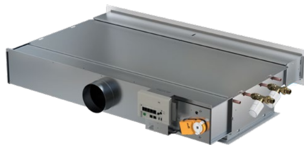
Figura 11. WISE Paragon, completo di centralina WISE CU installata di fabbrica, attuatori e valvole e attuatori valvole per l'acqua di raffreddamento e di riscaldamento.
