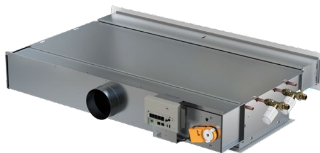
Figure 11. WISE Paragon complet avec module de commande WISE CU, servomoteurs, vannes et servomoteurs de vannes pour chauffage ou refroidissement par eau montés en usine.
