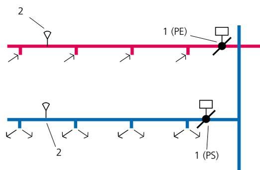
Figure 1. Régulation de pression constante, installation recommandée aux 2/3 de la gaine.
