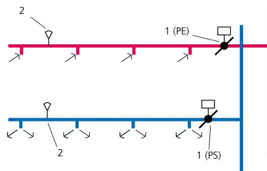
Abb. 1. Konstantdruckregelung, empfohlene Installation auf 2/3 der Kanallänge.
