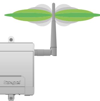
Figure 2. WISE DIR, distribution des signaux radio (distribution à 360° autour de l'antenne).
