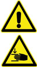
Wenn das Produkt mit Strom versorgt wird, öffnet oder schließt sich die Klappe. Dabei kann ein gewisses Risiko bestehen, dass Quetschverletzungen z. B. an Fingern auftreten, wenn sich diese zwischen den Klappenblättern befinden.
