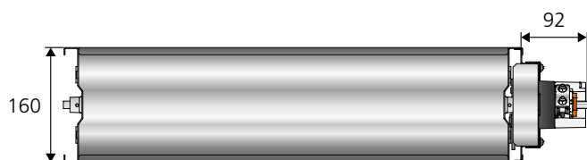
Abb. 7. Abmessungen (mm), REACT PX GMB, rechteckig.
