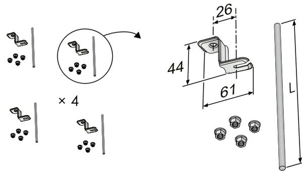
Figure 17. Élément d'assemblage SYST MS M8-1, montage au plafond et sur tige filetée
