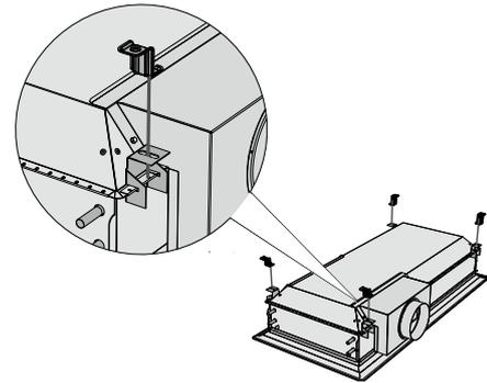
Figure 18. Suspension par quatre consoles avec SYST MS M8
