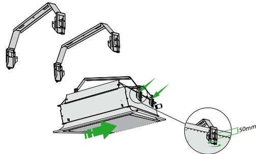
Figure 19. Fixation au moyen du KIT DE SUSPENSION RAPIDE PARASOL Z
