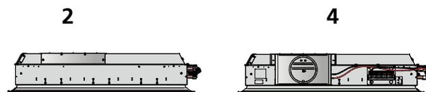
Figure 15. Raccordement aéraulique côté longueur, 2 ou 4.
