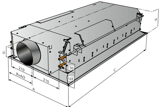
Figure 27. Schéma de dimensionnement – raccordement sur côté court (l'exemple montre une longueur 1200 avec raccordement aéraulique sur le côté 1).
