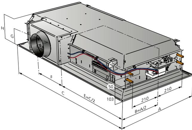
Figure 26. Schéma de dimensionnement – raccordement sur côté long (l'exemple montre une longueur 1200 avec raccordement aéraulique sur le côté 4).
