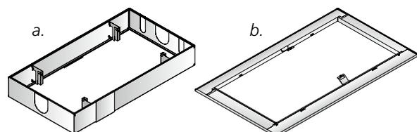
Figure 21. Accessoires pour montage suspendu
