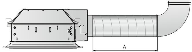
Figure 25. Schéma de dimensionnement, raccordement côté longueur, avec coude Ø125/160/200
