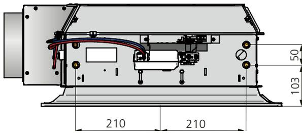
Figure 22. Dimensions, longueur du raccord hydraulique 600, 1200, 1800
