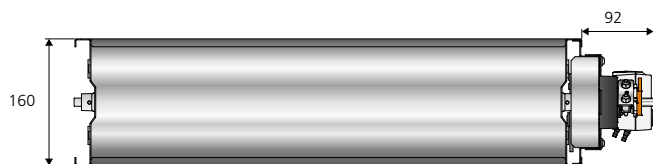
Figur 7. Mål (mm), REACT P GMB rektangulær.
