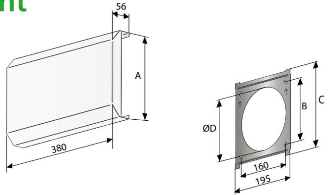
Abb. 3. SOTTO, Abmessungen.
