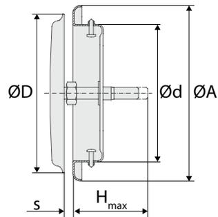
Abb. 5. TRAC, Abmessungen.
