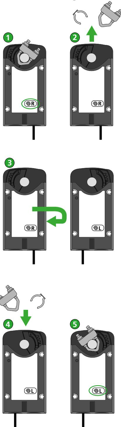
Abb. 11. Änderung der Laufrichtung.
