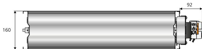
Abb. 7. Abmessungen (mm), REACT P GMB, rechteckig.
