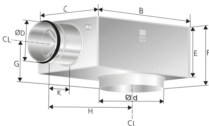
Abb. 1. Abmessungen (mm).
