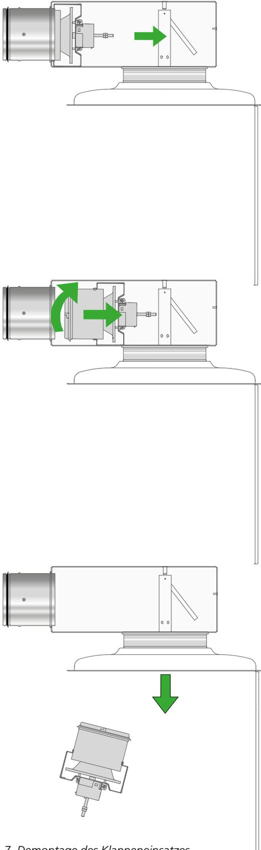
Abb. 7. Demontage des Klappeneinsatzes.
